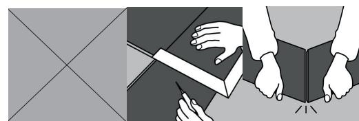
Die Elemente müssen spannungsarm und fugendicht in den Kleber eingelegt und angerieben werden. Innerhalb der offenen vorgeschriebenen Zeit des Klebers, muss sorgfältig mit einer Lamellenwalze angedrückt werden. Bis zur vollen Durchhärtung des Klebers ist der Boden vor Temperaturänderungen und Sonneneinstrahlung zu schützen.
